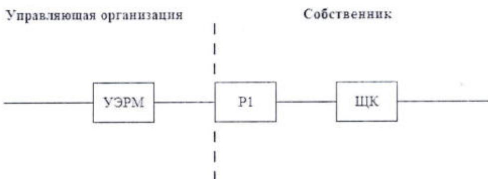
Исполнитель несет ответственность за надлежащее состояние и работоспособность питающих электрических сетей на квартиру согласно вышеуказанной схеме до прибора учета (пунктирной линии слева).
