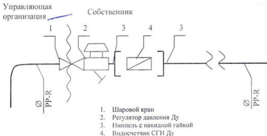
Исполнитель несет ответственность за надлежащее состояние и работоспособность систем горячего и холодного водоснабжения согласно вышеуказанной схеме до волнистой линии слева (включая шаровой кран).
